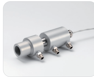
水冷空冷用ハウジング 型式 WJ 製品の型式記号の最後に接尾辞として付加水冷空冷用ハウジングを使用しますと70℃を超える周囲温度雰囲気で使用できます。センサのレンズ表面の結露を防止するためにこのハウジングはエアパーズカラーと一緒に提供します。このハウジン
