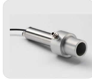
エアパーズ用カラー: APSW: 2:1用 APSN:その他 エアパーズカラーは埃、煙、湿気などその他塵埃をレンズから排除するため使用します。
