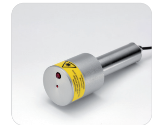
レーザー照準ツール 型式 LST: 測定対象を明確にするためにセンサの前部にネジ止めされます。一度、測定対象を特定した後、レーザー照準ツールは取り除くことができます。
