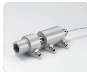
水冷空冷用ハウジング 型式 WJ 製品の型式記号の最後に接尾辞として付加水冷空冷用ハウジングを使用しますと70℃を超える周囲温度雰囲気で使用できます。センサのレンズ表面の結露を防止するためにこのハウジングはエアパーージカラーと一緒に提供します。このハウジン
