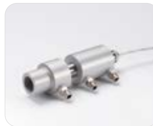
水冷空冷用ハウジング 型式 WJ 製品の型式記号の最後に接尾辞として付加 水冷空冷用ハウジングを使用しますと70℃を超える周囲温度雰囲気で使用できます。センサのレンズ表面の結露を防止するためにこのハウジングはエアパージカラーと一緒に提供します。このハウジン
